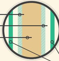
Épaisseur des panneaux sandwich ALUTECH : 40 et 45 mm.
