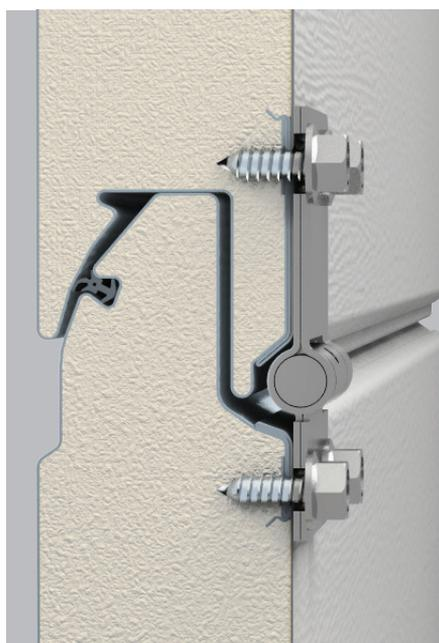
Les vis auto-perceuses sont placées à la jonction des tôles en acier tout en traversant **4 couches de métal** pour une résistance accrue. Un scellement robuste exclut tout cintrage d'un panneau suite à la chute inopinée du panneau.
