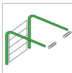
Ferrure de linteau surbaissé, installation dans une ouverture de type «tunnel»
